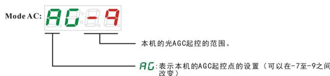
以下两项菜单为反向光发组件是连续发光模式的状态显示，如果此机器不配置反向发射组件则此两项显示为隐藏。
