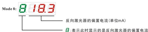
以下两项菜单为反向光发组件是突发发光模式的状态显示，如果此机器不配置反向发射组件则此两项显示为隐藏。
